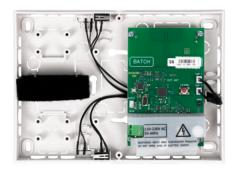
Der FUNK-Repeater dient zur Reichweitenverlängerung von Funkkomponenten des JA 100 Alarmsystems.
