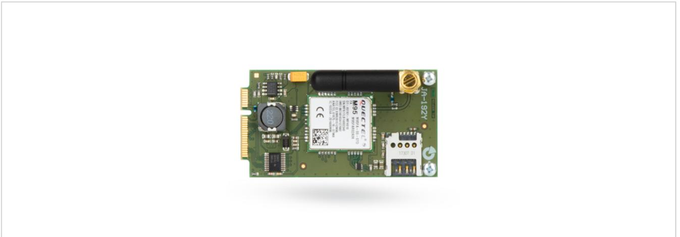
Das GSM/GPRS-Übertragungsgerät mit MicroSIM-Slot eignet sich für die Zentralen JA-103K oder JA-107K, die zum System JABLOTRON 100+ gehören.
