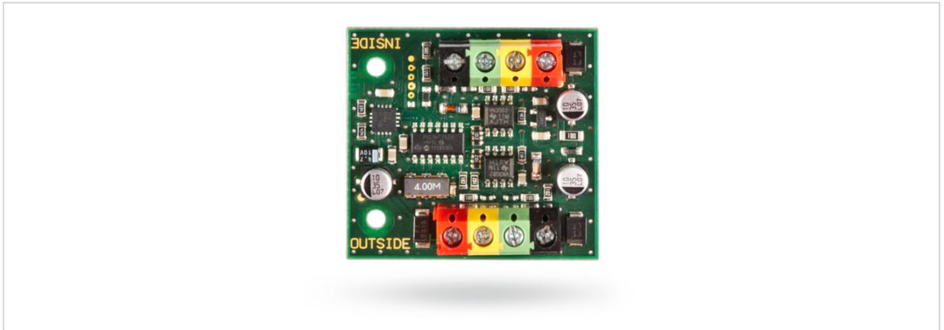
Der BUS-Isolator von Jablotron dient zur galvanischen Trennung und zum Schutz der Bus-Verkabelung.
