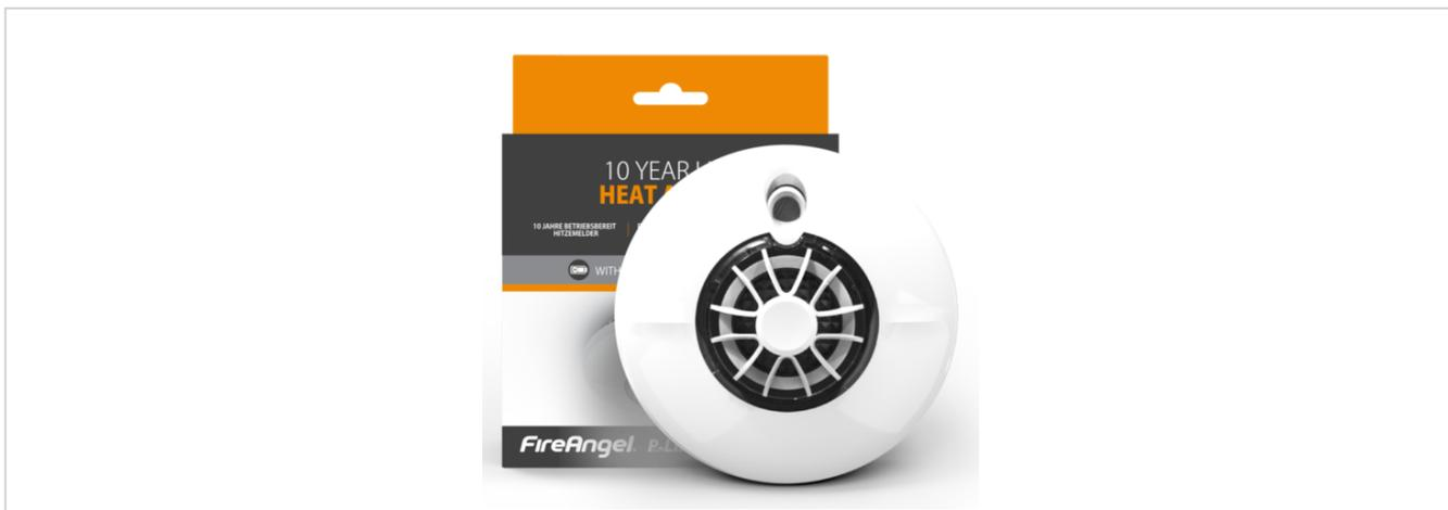
Der Hitzemelder FireAngel HT-630-EU überwacht mit seiner Thermistek-Technologie permanent die Temperaturveränderungen im Raum. Der Thermodifferentialmelder der Klasse A1 hat eine Ansprechtemperatur von 54 °C bis 62 °C.
